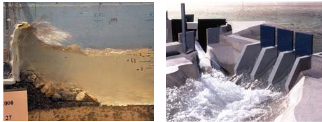
Figure 3 : Vague déferlant sur une digue en enrochement (gauche) et modèle réduit d'un évacuateur de crue (droite).
