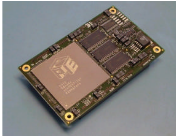
Un des 16 modules (15x30 cm) constituant la carte. On distingue le processeur (carre noir au sigle APE), les mémoires, les bus de communication et l'alimentation électrique.
